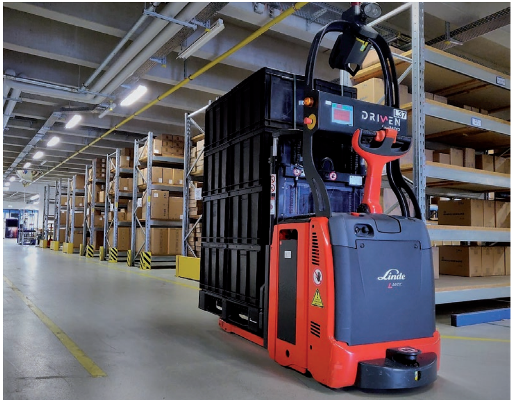
In den Werken erledigen fahrerlose Transportfahrzeuge die unterschiedlichsten Logistikaufgaben.
